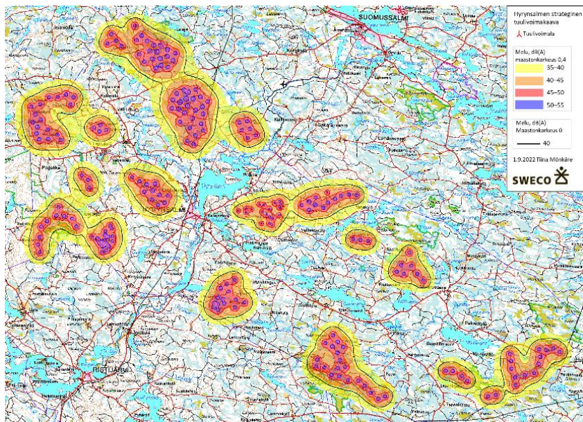
Kuva 40. Melukartta mallinnetuille tuulivoimaloille. Väreillä on osoitettu melualueet, jotka mallinnettu maastonkarkeuskertoimella 0,4. Oranssilla alueella ylittyy 40 dB. Musta viiva on 40 dB:n raja mahdollisessa maksimitilanteessa, jossa maasto olisi kauttaaltaan kovaa (kerroin 0).
